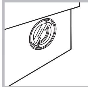
2. odskrutkujte veko otáčaním proti smeru hodinových ručičiek (*viď obrázok*): vytiečenie malého množstva vody je úplne bežným javom;
